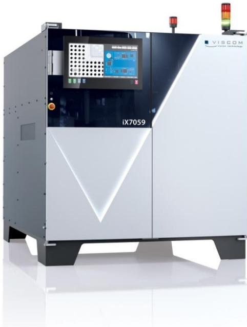
01\_ix7059 PCB Inspection XL: Neue 3D-Inline-Röntgeninspektion mit CT für die High-End-Elektronikfertigung
