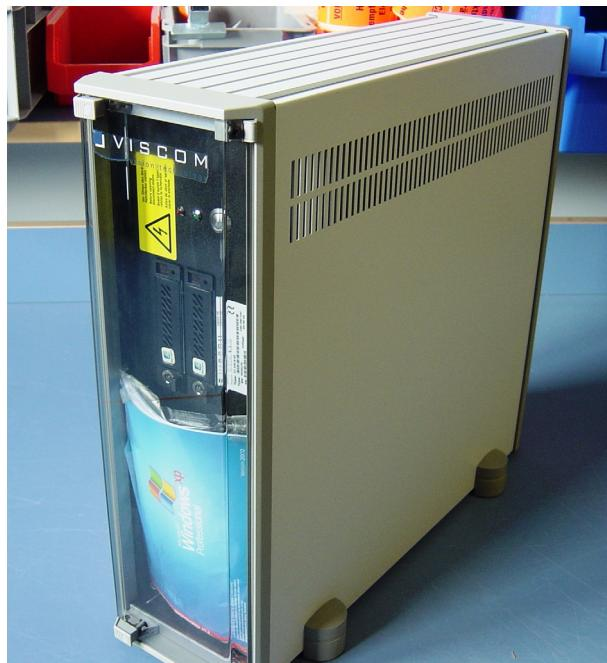
2. Nehmen Sie ein für die Verpackung des Systemrechners ausreichend großes Stück ESD-taugliche Luftpolsterfolie und wickeln Sie den Systemrechner ein.
