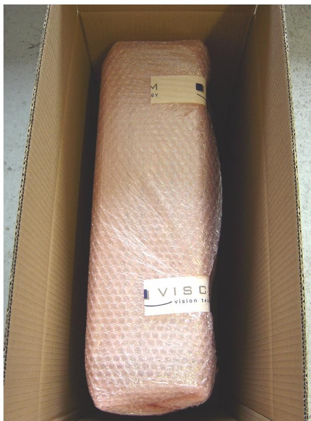
7. Schützen Sie die beiden oberen Kanten des Rechners mit geeignetem Polstermaterial.
