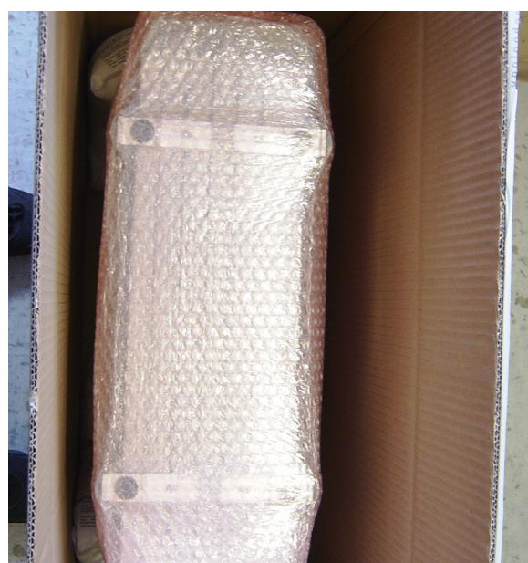
**10.** Schützen Sie nun ebenfalls die beiden unteren Kanten des Rechners mit geeignetem Polstermaterial.
